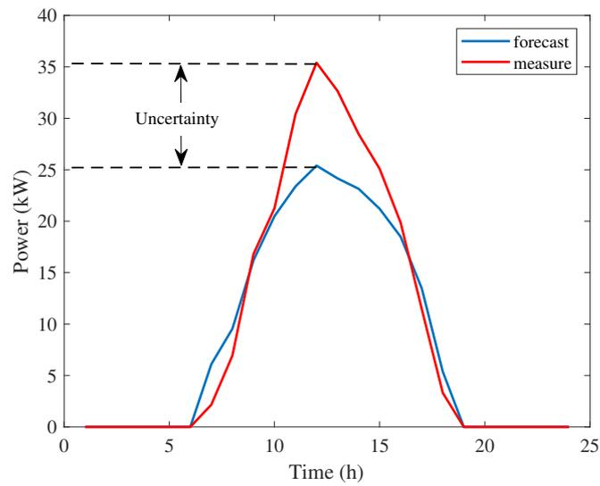
Figure 4. Forecast and actual PV power data.
