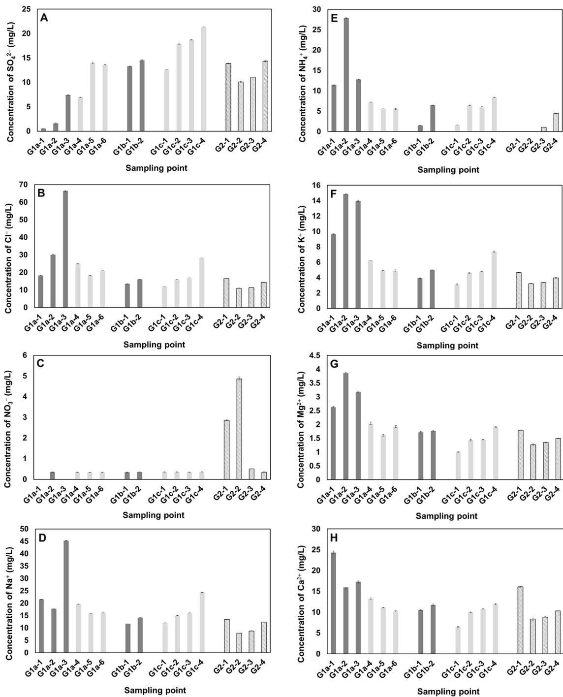
Figure 3. Changes in ionic concentrations: (A)  $SO_4^{2-}$ ; (B)  $Cl^-$ ; (C)  $NO_3^-$ ; (D)  $Na^+$ ; (E)  $NH_4^+$ ; (F)  $K^+$ ; (G)  $Mg^{2+}$ ; and (H)  $Ca^{2+}$  in the Galing River.
