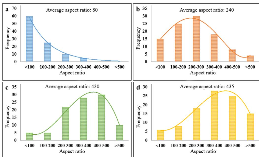
**Figure 3.** Influence of CTAB on the aspect ratios of  $\alpha$ -CaSO<sub>4</sub>·0.5H<sub>2</sub>O whiskers CTAB (mol·L<sup>-1</sup>): (a) 0; (b)  $1.0 \times 10^{-4}$ ; (c)  $9.2 \times 10^{-4}$ ; (d)  $1.5 \times 10^{-3}$ .
