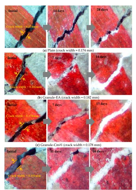
(d) Granule-Cm#2 (crack width = 0.191 mm)
