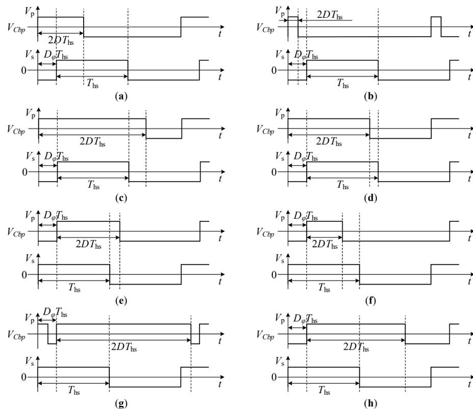
**Figure 3.** ADM operation mode classification: (a) mode A; (b) mode B; (c) mode C; (d) mode D; (e) mode E; (f) mode F; (g) mode G; (h) mode H.
