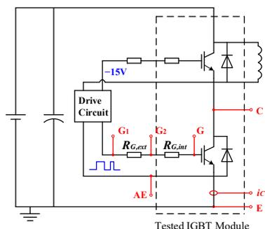
Figure 11. IGBT module parameter extraction circuit.
