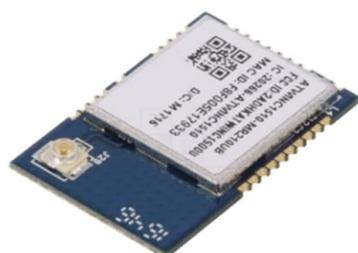
**Figure 7.** Wi-Fi module WINC1510.
