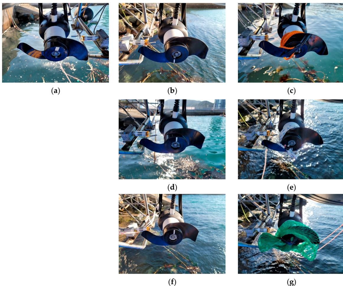
**Figure 10.** Test cases: (a) Normal(healthy); (b) Breakage 7%; (c) Thin rope entanglement; (d) Breakage 14%; (e) Rope entanglement; (f) Breakage 21%; and (g) Net entanglement.
