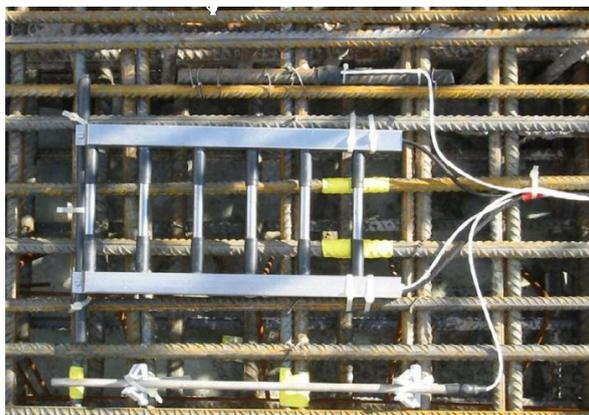
**Figure 2.** Nagel-System sensor.
