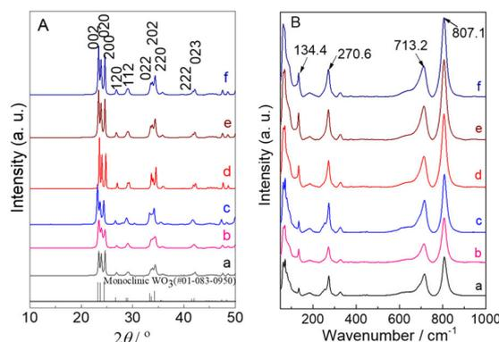
**Figure 3.** (A) XRD patterns and (B) Raman spectra of (a)  $\text{WO}_3\text{--}0$ , (b)  $\text{WO}_3\text{--}0.62$ , (c)  $\text{WO}_3\text{--}1.2$ , (d)  $\text{WO}_3\text{--}2.5$ , (e)  $\text{WO}_3\text{--}5$ , and (f)  $\text{WO}_3\text{--}7.5$ , respectively.
