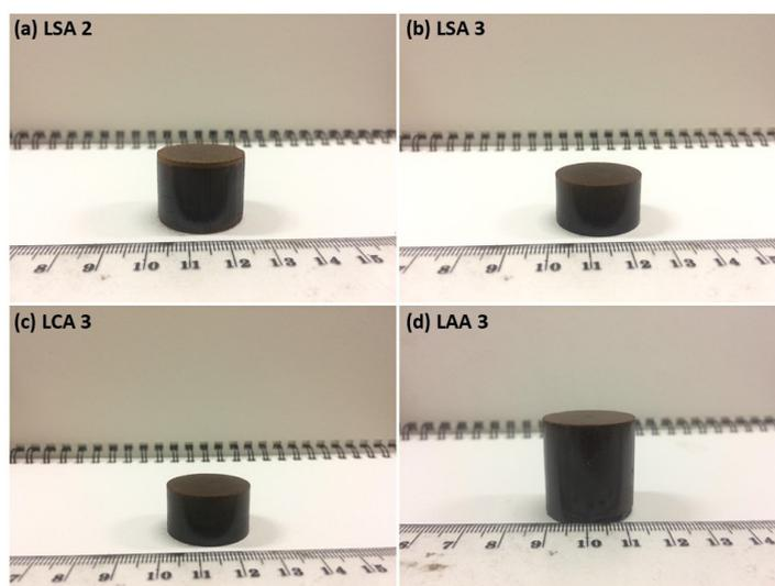
**Figure 12.** Lignin briquette of (a) LSA2, (b) LSA3, (c) LCA3, and (d) LAA3.
