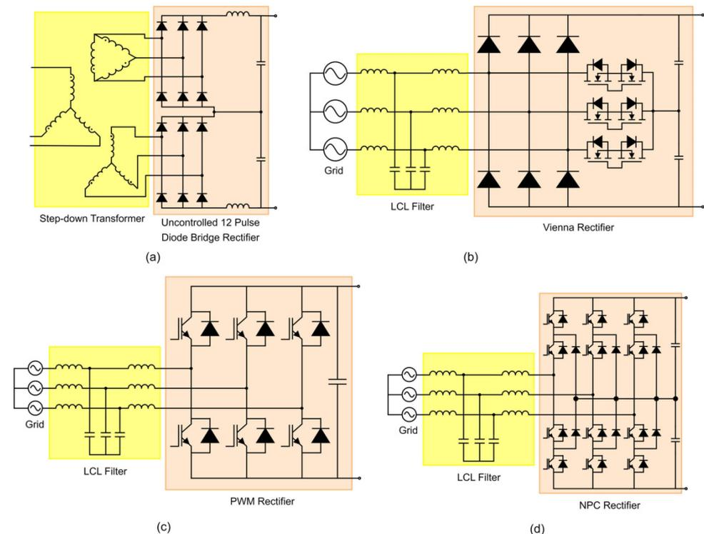
**Figure 8.** The most common AC/DC rectifiers: (a) 12-pulse diode bridge rectifier; (b) Vienna rectifier; (c) PWM rectifier; (d) NPC rectifier.
